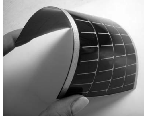
Rysunek 4.1. Elastyczne ogniwo firmy UniSolar wykonane z krzemu amorficznego z elektrodami srebrowymi wykonanymi sitodrukiem. Zdjęcie: Politechnika Łódzka
