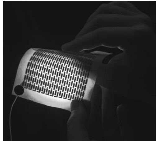
Rysunek 4.2. Elastyczne ogniwo drukowane metodą sublimacji na podłożu papierowym, wykonane w Minnesota Institute of Technology, w Stanach Zjednoczonych. Zdjęcie: Patrick Gillooly
